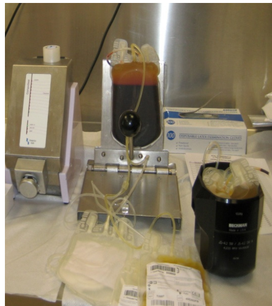
Εικόνα 19. σύστημα πίεσης ασκών ανατύπωση από την Αιμοδοσία του Γ.Ν.Α. Γ. Γεννηματάς
