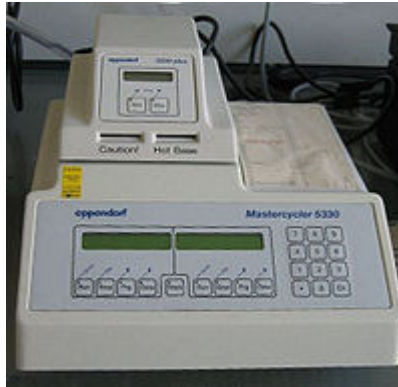
Εικόνα 8. Ειδικό μηχάνημα, θερμοκυκλωτής (thermal cycler), για PCR.
