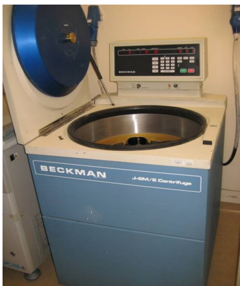
Εικόνα 9. φυγόκεντρος ασκών ολικού αίματος ανατύπωση από την Αιμοδοσία του Γ.Ν.Α. Γ. Γεννηματάς
