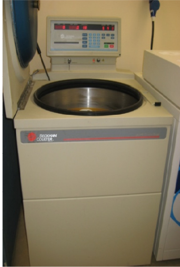
Εικόνα 11. φυγόκεντρος ασκών ολικού αίματος ανατύπωση από την Αιμοδοσία του Γ.Ν.Α. Γ. Γεννηματάς
