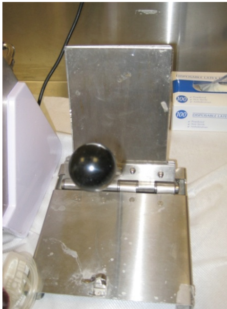
Εικόνα 18. σύστημα πίεσης ασκών ανατύπωση από την Αιμοδοσία του Γ.Ν.Α. Γ. Γεννηματάς
